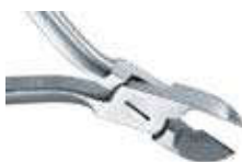
Лигатурные кусачки Medium Стерилизуемые Для отрезания проволок и дуг. Вставки из твердого металла. Мы не рекомендуем использовать переднюю треть этих щипцов для отрезания проволок с максимальными показателями толщины! Максимальная толщина проволоки \varnothing : 0.70 \text{ мм} , жесткая
