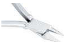
Щипцы Адамса Maxi С одной гладкой прямоугольной и одной гладкой закругленной щечками. Максимальная толщина проволоки Ø: 0.8 мм, жесткая
